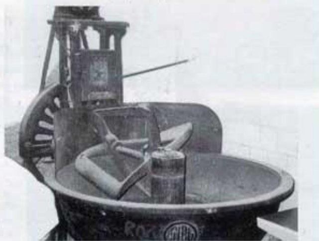
Tahona o amassadora. Aquesta màquina s'utilitzava per a fer la pasta. Podia amassar fins 150 kg. de farina. Evidentment no la utilitzaven els particulars; era per a l'ús dels forners que es dedicaven de ple a fer pa. Aquesta és d'un forn que durant molts anys va fer pa per als covarxins, el forn d'Andrea.
