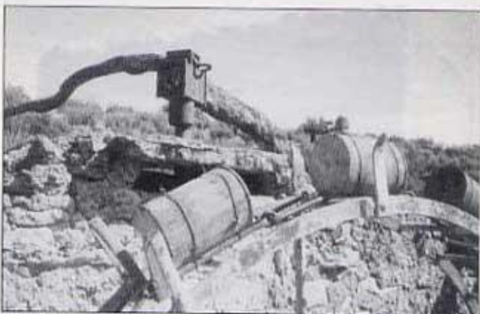
Roda, cadufs i rest de ferro. A la base dels cadufs hi ha un forat que té dues funcions: deixar eixir l'aire quan el caduf està omplint-se -si els cadufs no bevien bé, s'embolicava el rest-, i deixar eixir l'aigua quan s'acaba de regar. En la roda es poden veure les guies i les orelles. Les guies són les dues peces en forma de M de l'esquerra. Guien al rest pel centre de la roda. En les sènies modernes, les guies eren dues barres de fusta, que vivint de la paret lateral i recolzant-se en un travesser, guien al rest d'espert.
